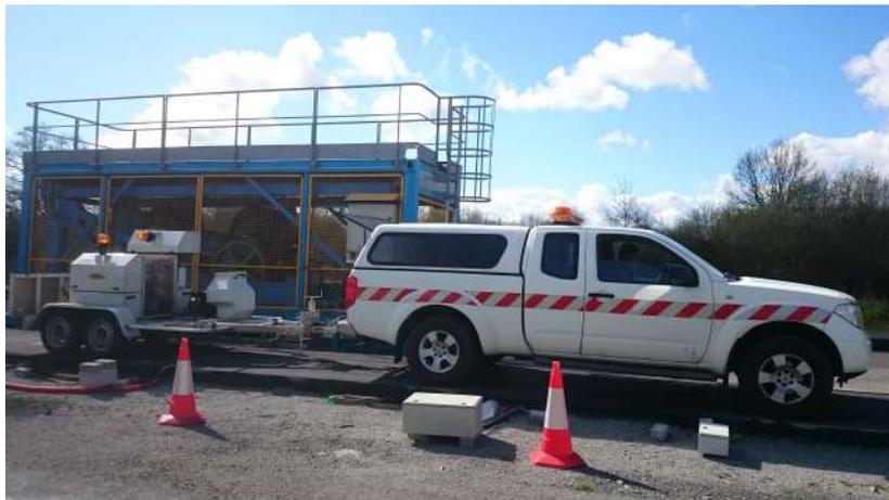
FIGURE 6.2 – Défléctomètre à masse tombante (FWD)(photo prise à l'IFSTTAR)
