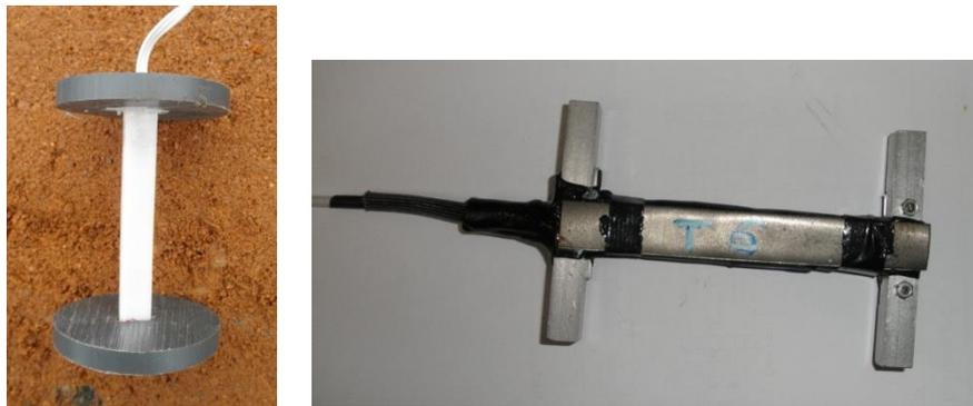
Figure 2.4. Jauge de déformation verticale (a) et jauge de déformation horizontale (b) (longitudinale ou transversale)
