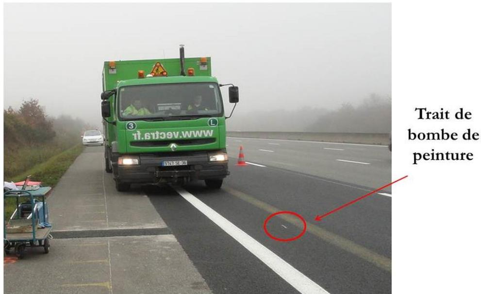
Figure 3.1. Repérage de l'emplacement des capteurs par un trait de bombe de peinture (mesures effectuées le 15 novembre 2011)
