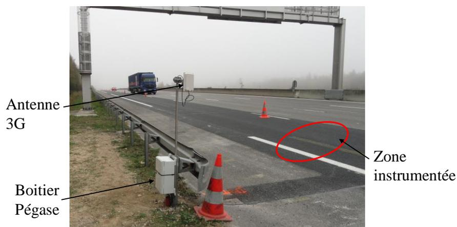
Figure 2.19. Photo de la section instrumentée sur l'autoroute A10.
