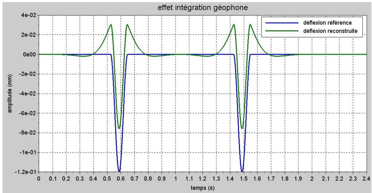
Figure 6.19. Illustration de l'effet de l'intégration numérique appliqué à des « demi-sinus » (le signal reconstruit est issu de la dérivation puis de l'intégration du signal initial)
