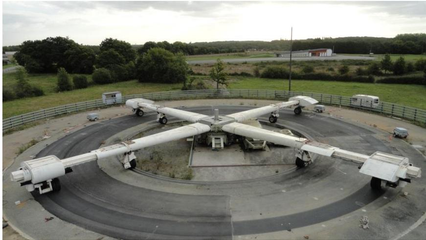
Figure 6.27. Manège de fatigue de l'IFSTAR Nantes.
