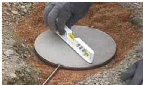
Figure 1.10. Capteur de pression
