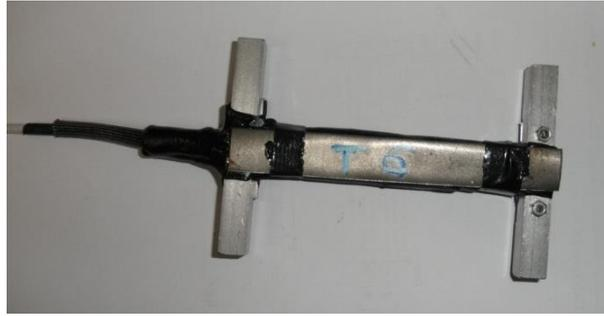
Figure 1.6. Jauge de déformation horizontale en aluminium avec protection
