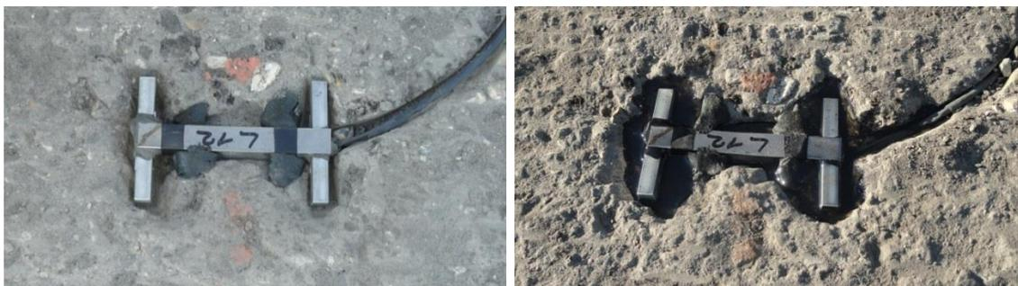
Figure 2.6. Mise en place des jauges longitudinales au sommet de la couche Recyvia
