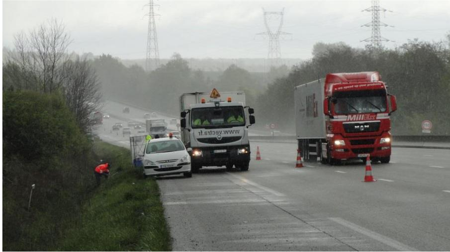
Figure 3.2. Réalisation des mesures de jauges sous le passage d'un déflectographe sur l'autoroute A10 (avril 2012)
