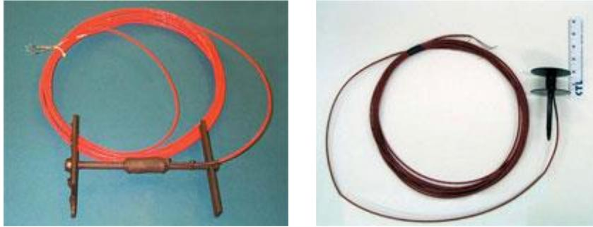
Figure 1.8. Jauges de déformation CTL (ASG-52: horizontale; VS: verticale)
