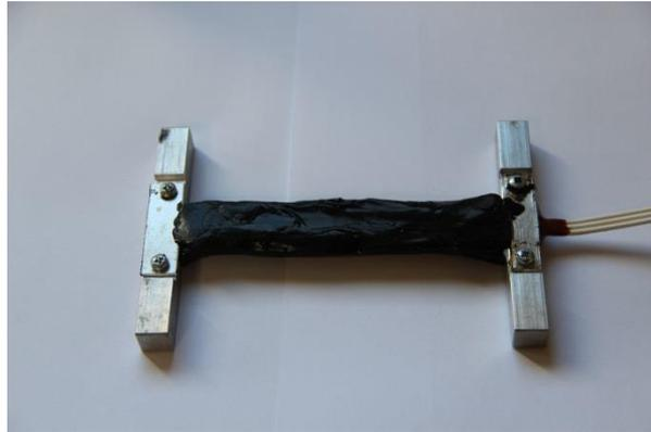
Figure 1.4. Jauge de déformation Kyowa avec la résine de protection
