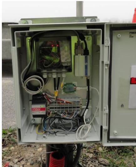
Figure 2.18. Boîtier contenant le système de conditionnement et de transmission des données sur l'A10
