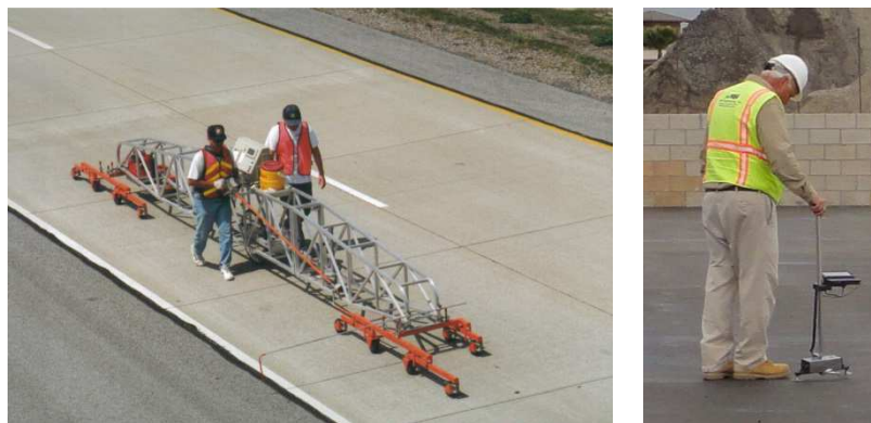
Figure 1.7 : Mise en œuvre d'un profilographe (vue de gauche) et du Dipstick Profiler (vue de droite)
