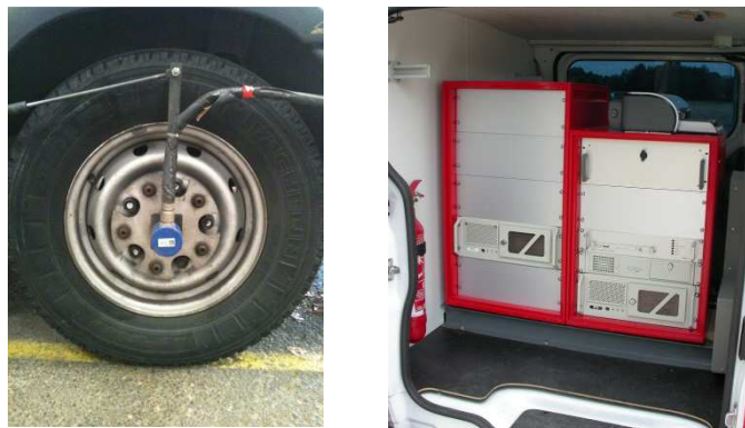
Figure 1.11 : Codeur installé sur la roue d'un véhicule d'essai et exemple de système informatique embarqué
